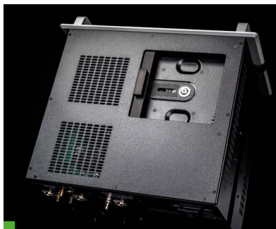
Obecność 5 lamp w środku sprawia, że odtwarzacz solidnie się nagrzewa, a zatem wymaga dobrej wentylacji.
