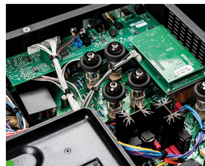
Lampowy tor wyjściowy jest zbudowany z triod 6H30. Pod płytką cyfrową skrywają się okazałe kondensatory foliowe.
